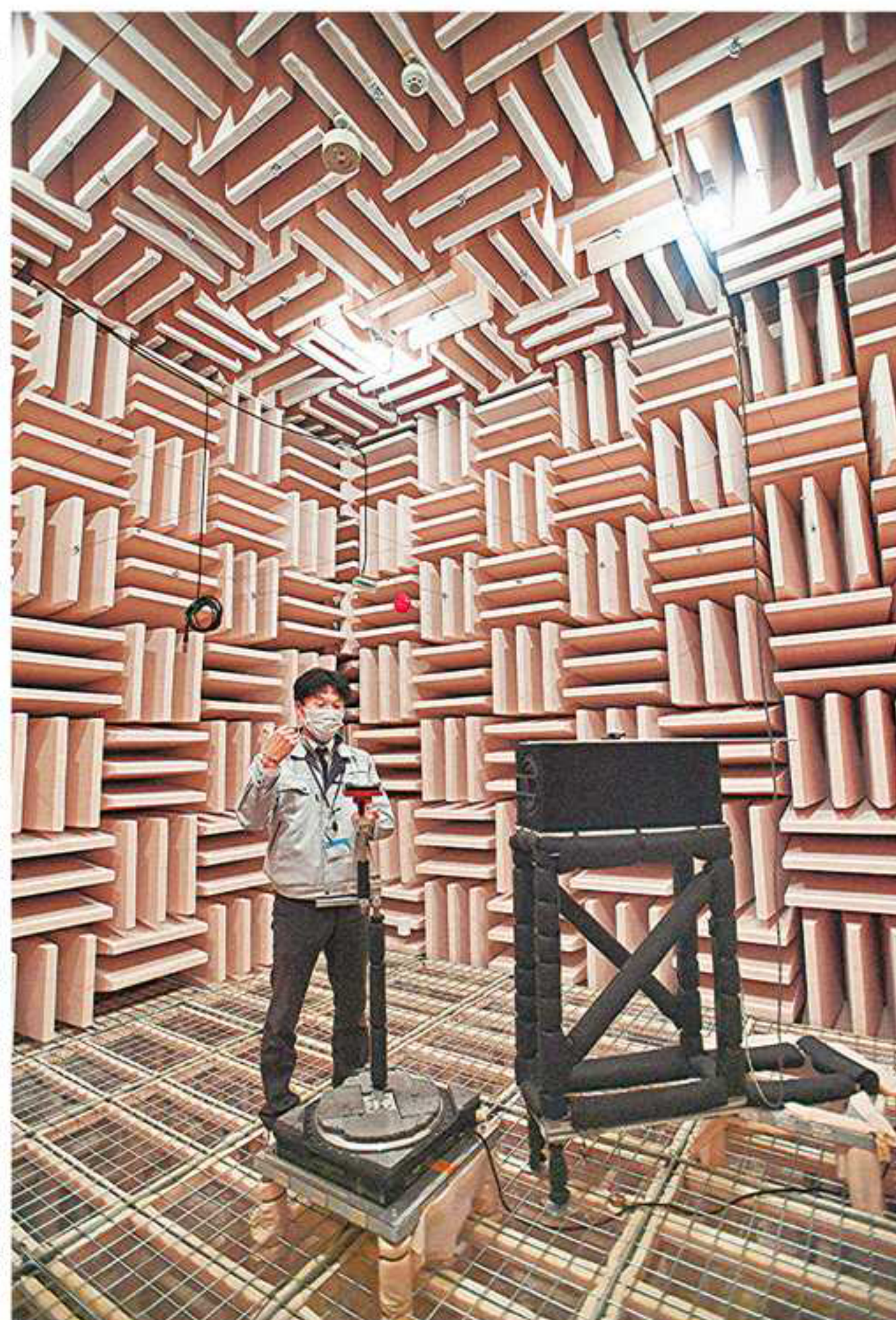
音を遮断、吸収する無響室。マイクホンやヘッドホンなど音響製品の測定には不可欠な測定設備だ
