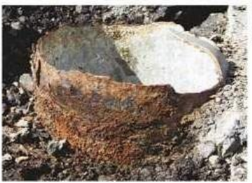
① 腐食して倒れた信号機 ② 信号機の根元部分=いずれも三重県鈴鹿市で(同県警提供)
