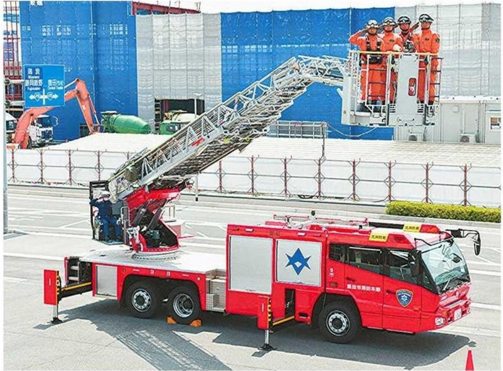
4人が乗れる大型バスケットを装備した新型はしご消防車。背後には建設が進む大型商業施設が見える＝豊田市四郷町で
