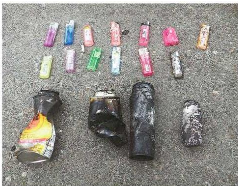
ごみ収集車の火災の火元とみられる、黒く焼け焦げたスプレー缶。いずれも市内で（市消防局提供）
